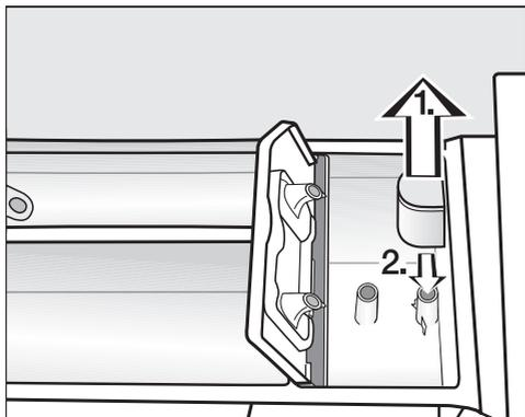
1. Trekk ut sugeheverten fra kammer ☼ og rengjør under rennende varmt vann. Rengjør også røret som sugeheverten settes på.
