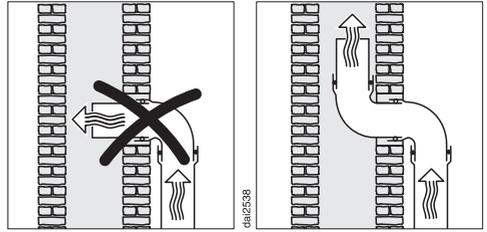
Skal utluftningen føres i en utluftningskanal, må innføringsstussen styres i strømningsretningen.
