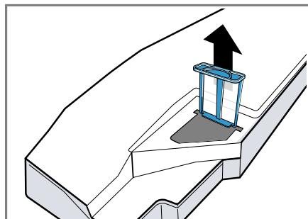
3. Rengjør filteret i varmt, rennende vann eller i oppvaskmaskinen.
