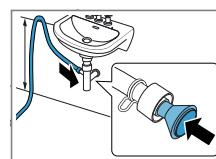
Sikre koblingspunktet med en slangeklemme (12–22 mm). Fest avløpsslangen med en slangeføring i en høyde på minst 80 cm og maks. 100 cm.
