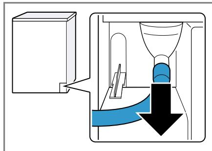
Kondensvannslangen er koblet til stussen fra fabrikk.
