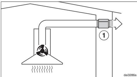
Ved utluftningsdrift demper lyd-demperen både lyden fra viften som går utover, i tillegg til lyder fra utsiden som trenger inn i kjøkkenet gjennom utluftningsrøret (f.eks. støy fra veien). Lyddemperen blir posisjonert så nært som mulig foran utluftningsutløpet ①.
