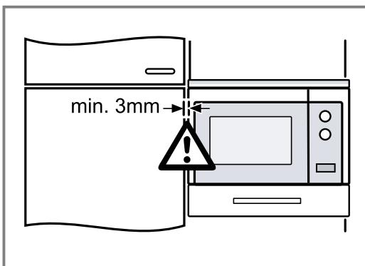
Afstanden til de tilstødende apparater skal minimum være 3 mm.
