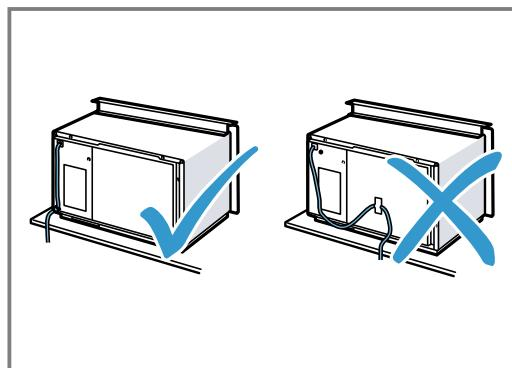
Sett apparatet inn i skapet og skyv det til høyre.
