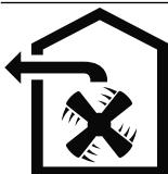
Luften må ikke ledes ud gennem en skorsten, der bliver anvendt til afledning af røggasser fra apparater, der forbrænder gas eller andre brændstoffer (dette gælder ikke for apparater med recirkulationsdrift).
