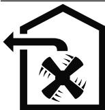
Luftens skal ikke ledes til rør som brukes til avgassene fra apparater som forbrenner gass eller andre brennstoffer (dette gjelder ikke ved sirkulasjonsdrift).
