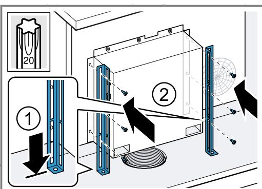
10. Skruva fast skenorna på stombotten.
