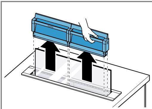
**3.** Asenna rasvasuodattimet paikoilleen rasvasuodatinkasetteihin.
