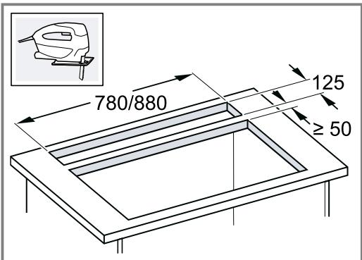
Det må være  $90^\circ$  vinkel på snittflaten i forhold til benkeplaten.
