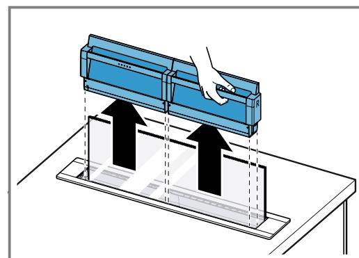
3. Sæt fedtfiltrene på plads i fedtfILTERkassetten.
