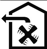
Luftet må ikke ledes ud gennem en skorsten, der bliver anvendt til afledning af røggasser fra apparater, der forbrænder gas eller andre brændstoffer (dette gælder ikke for apparater med recirkulationsdrift).
