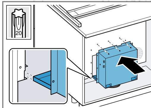
7. Tue laitetta alhaalta pään ja poista listat.
