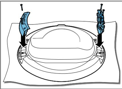
Pass på at du ikke klemmer inn eller skader dørtetningen.
