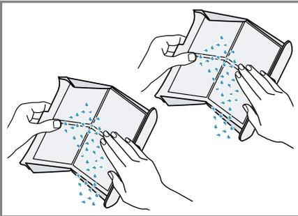
8. Vask de to lofiltrene grundig i rennende, varmt vann og tørk dem.
