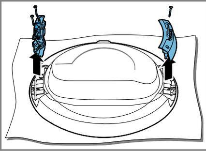
3. Skru på dørhengselet og dørkroken på motsatt side.
