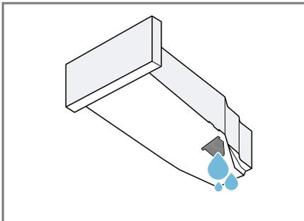
Kontroller filteret i kondensvannbeholderen → Side 46 regelmessig og rengjør det når det er skittent. Påse at kondensvannbeholderen er skjøvet inn før maskinen brukes. → "Skyve inn kondensvannbeholderen", Side 36
