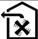
Luften må ikke ledes ud gennem en skorsten, der bliver anvendt til afledning af røggasser fra apparater, der forbrænder gas eller andre brændstoffer (dette gælder ikke for apparater med recirkulationsdrift).
