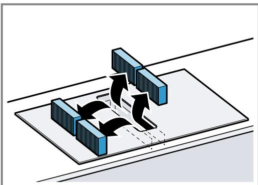
4. Sett inn de 2 luftfiltrene eller støyfiltrene på venstre og høyre side i apparatet, og skyv dem forover.
