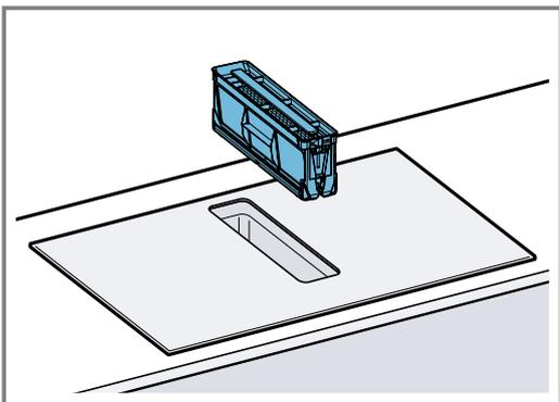
3. Ta ut de 4 luftfiltrene eller støyfiltrene og kast dem forskriftsmessig.
