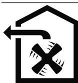
Luften skal ikke ledes til rør som brukes til avgassene fra apparater som forbrenner gass eller andre brennstoffer (dette gjelder ikke ved sirkulasjonsdrift).
