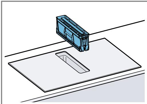
3. Ta ut de 4 luktfiltrene eller støyfiltrene og kast dem forskriftsmessig.
