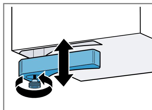
**2. Tøm og skyll overløpsbeholderen.****3. Skru løs overløpsbeholderen og vask den uten skruen i oppvaskmaskin ved behov.****4. Skru fast overløpsbeholderen på plass igjen etter rengjøring.****5. Forsikre deg om at innløpet til overløpsbeholderen ikke er blokkert.**
