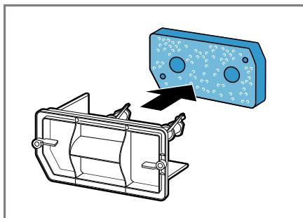
Pass på at du ikke deformerer eller skader filtermatten.
