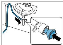
Sikre koblingspunktet med en slangeklemme (12–22 mm). Fest avløpsslangen med en slangeføring i en høyde på minst 80 cm og maks. 100 cm.
