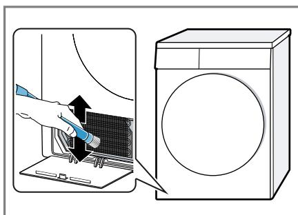
Pass på at du støvsuger lamellene ovenfra og ned, og at du ikke bøyer eller skader dem under rengjøringen.
