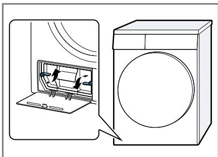
3. Trekk ut varmevekslerdekselet etter håndtaket.
