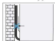
Pass på at ingen slanger eller strømledninger kommer i klem mellom veggjen og apparatet.
