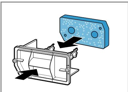
Pass på at du ikke deformerer eller skader den rengjorte filtermatten eller setter feil side på holderne.
