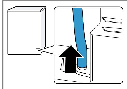
Kondensvannslangen er koblet til stussen fra fabrikk.
