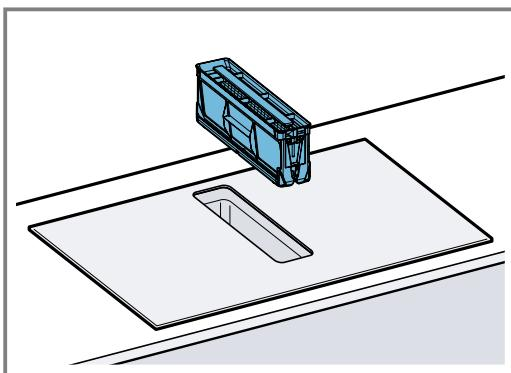
3. Ta ut de 4 luktfiltrene eller støyfiltrene og kast dem forskriftsmessig.
