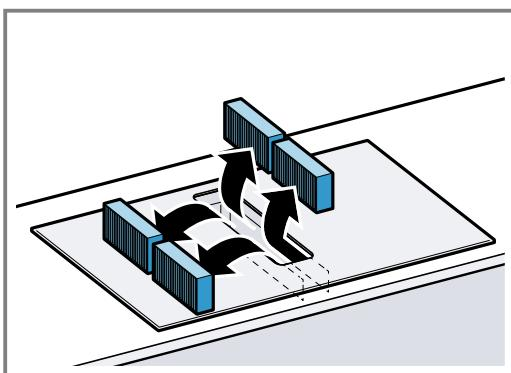
4. Sett inn de 2 luktfiltrene eller støyfiltrene på venstre og høyre side i apparatet, og skyv dem forover.
